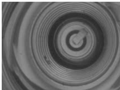
Bild 1. Zündkerzen-gewinde mit Fehler
