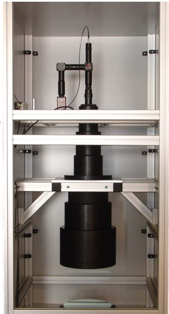
Bild: Prüfung eines Teleskops in doppeltem Durchgang. Links ist das optische Schaltbild dargestellt. Die Vermessung und Justage des großen Teleskops erfolgt direkt in dem System, in dem es später ein Teil des Messsystems selbst ist.
