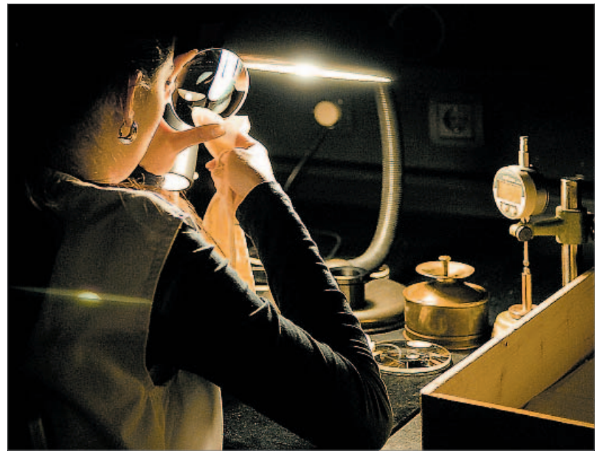
Impressionen aus der Fertigung bei Sill Optics: In Reihen und Glied und liegen größere Linsen bereit, um in einem Vakuumschrank oberflächenveredelt zu werden (oben). Die polierten Linsen werden in abgedunkelten Räumen penibel überprüft (Mitte). Berndt Zingrebe überprüft die Maße einer vorgeschliffenen Linse (unten).
