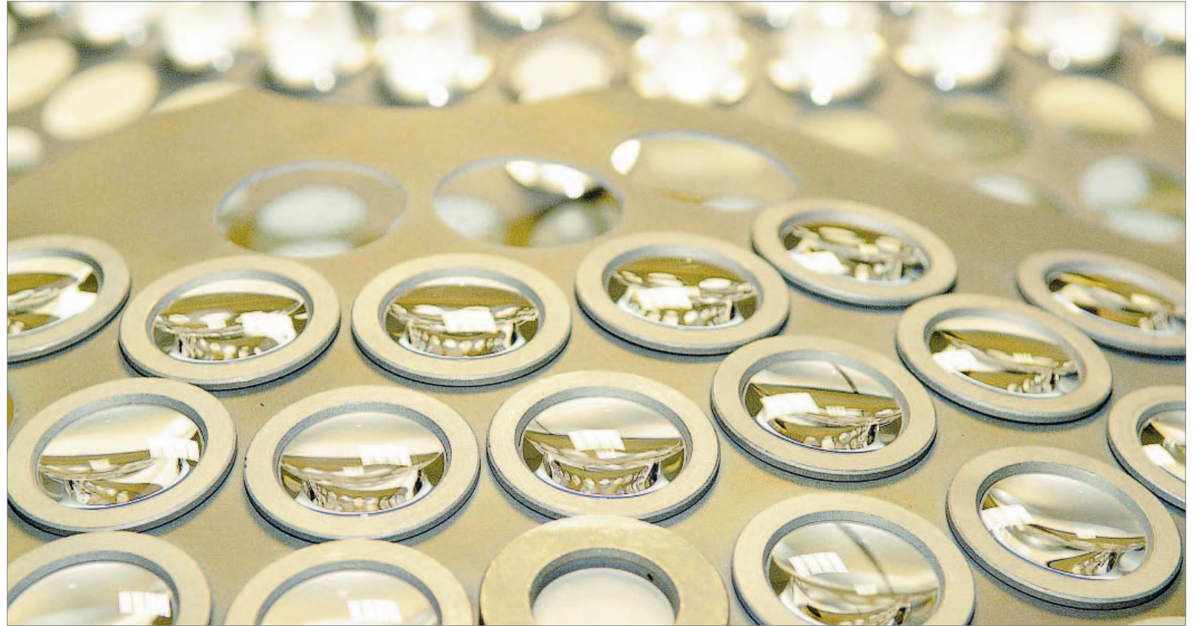
Impressionen aus der Fertigung bei Sill Optics: In Reihen und Glied und liegen größere Linsen bereit, um in einem Vakuumschrank oberflächenveredelt zu werden (oben). Die polierten Linsen werden in abgedunkelten Räumen penibel überprüft (Mitte). Berndt Zingrebe überprüft die Maße einer vorgeschliffenen Linse (unten).
