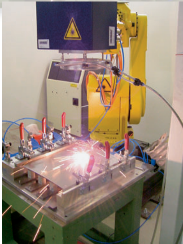
Bild 1: Remote-Welding-Systeme (engl. remote = fern) ermöglichen eine hochdynamische, präzise Positionierung des Laserstrahls für die Materialbearbeitung
